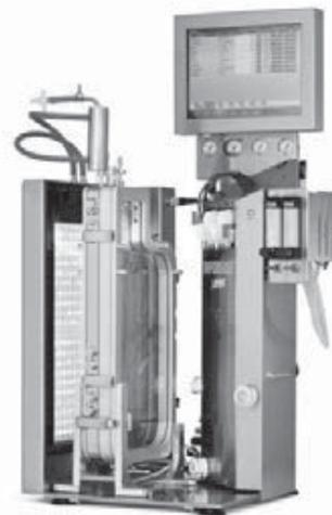
de simuler une courbe de lumière diurne. Les LED à lumière chaude blanche sont standard, diverses couleurs existent en option. Avec une valeur d'environ 3000 µmol/m2s, l'intensité maximale de rayonnement est comparable à celle du soleil de midi dans les Caraïbes.
